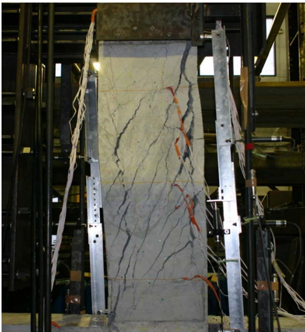
鉄筋コンクリート柱の破壊実験 Loading test of reinforced concrete column
