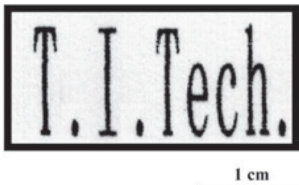
図6 インクジェット反応法により、ろ紙上に室温で形成され PbS パターン
