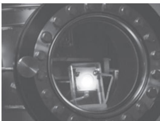
図-12 C12A7:e<sup>-</sup>を用いた電界電子放射デバイスが動作している様子
