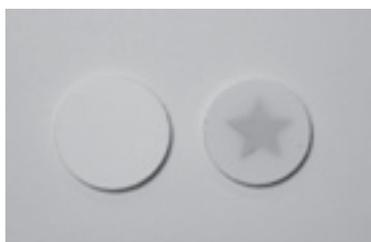
図-2 C12A7:O<sup>-</sup>によるPtの酸化。(左) O<sup>-</sup>が高濃度に含有されている試料。(右) Ptが酸化され褐色に着色している。
