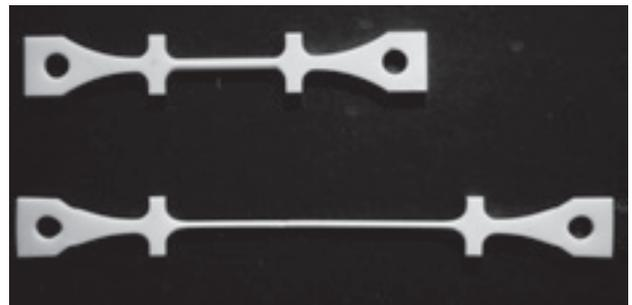
図1 イットリア安定化正方晶ジルコニア多結晶体(Y-TZP)の超塑性の最初の発見<sup>2)</sup>
