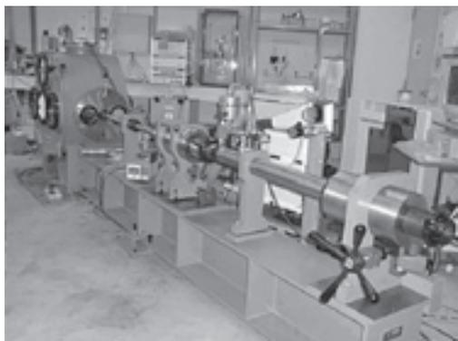
図-1 2段式軽ガスガンの外観
