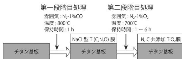
Fig. 1 二段階熱酸化法による炭素・窒素共添加 TiO 2 膜作製プロセスの模式図
