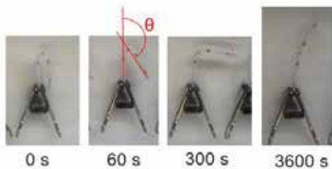
Fig.7 形状記憶試験時の試験片の時間変化 (38°C)
