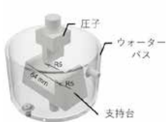
Fig.1 ウォーターバス付き 3 点曲げ試験用治具 の 3D モデル
