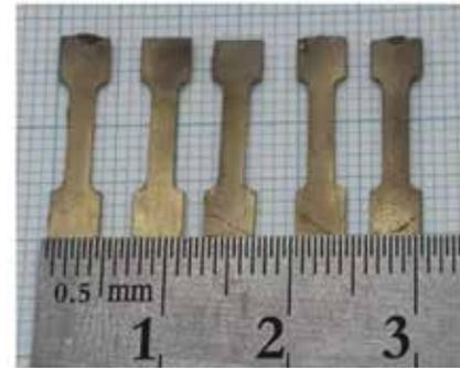
Fig. 3 Au-27Cu-18Al-2Fe 合金の鑄造結果
