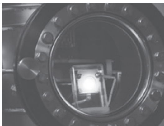
図-12 C12A7:e - を用いた電界電子放射デバイスが動作している様子
