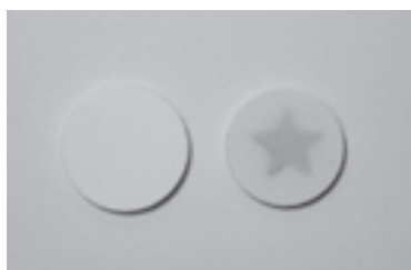
図-2 C12A7:O - によるPtの酸化。(左) O - が高濃度に含有されている試料。(右) Ptが酸化され褐色に着色している。
