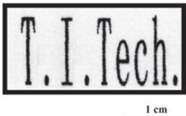
図6 インクジェット反応法により、ろ紙上に室温で形成され PbS パターン
