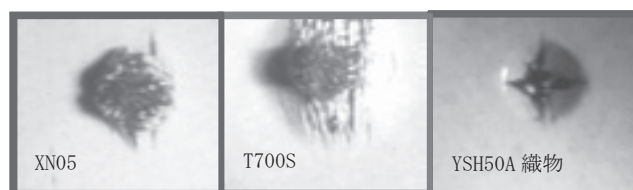
図-6 衝突速度約 900m/s での CFRP 後面の in-situ 観察
