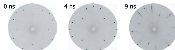
図1. 2次元ラウエ回折像。図中の時間は試料全面に衝撃波が到達してから経過時間。
