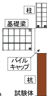
実験状況(既往) 杭径800mm(過去最大級の実験)
