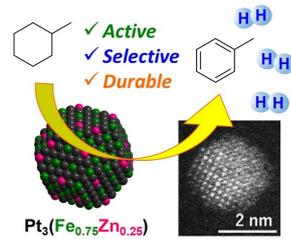
また詳細な反応機構解析をよびDFT計算から、Feは触媒上への炭素質の析出を抑制し、またZnは生成物であるトルエンの脱離を促進することでそれぞれ副反応を抑え、選択性および耐久性の向上に寄与していることが示された。特にZnは、他の金属種とは異なり、合金化によりPtの電子密度を増加させる働きがあることがXPSによる検討から判明した。
