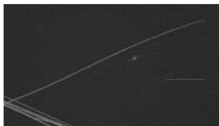
図 1. \text{Nb}_4(\text{Fe, Si})\text{Te}_4 ウィスカー結晶の電子顕微鏡像. 図中の直線は 0.1 mm を示す.
