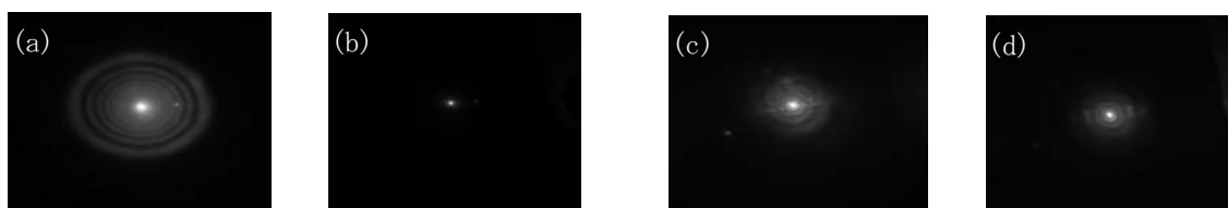
図 4 透過光写真: プロブ光の偏光方向がポンプ光の偏光方向と平行: (a) PhAMB-1T, (c) MB-TTPA; プロブ光の偏光方向がポンプ光の偏光方向と垂直: (b) PhAMB-1T; (d) MB-TTPA.
