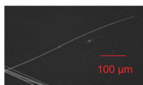
上図: Nb_4(Fe, Si)Te_4 ウィスカー結晶の電子顕微鏡像。 右図: Nb_4(Fe, Si)Te_4 ウィスカー結晶の磁化率の温度依存性。 T_g はスピングラス転移温度。
