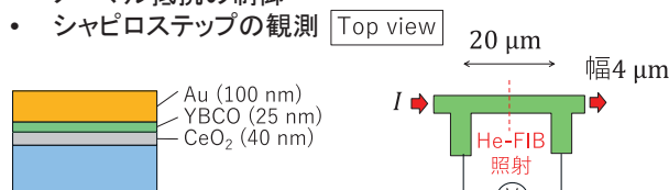
実験に使用したYBCO薄膜の断面模式図(左)と作製した四端子測定バー型素子の模式図(右)
