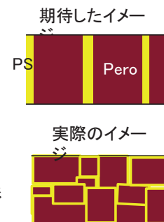
図2 ペロブスカイト膜のSEM像の比較
