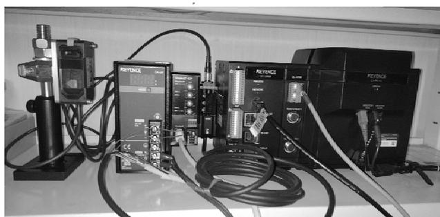
図1 新規に取り揃えたO社の変位計(より長距離のその場変位計測のため)
