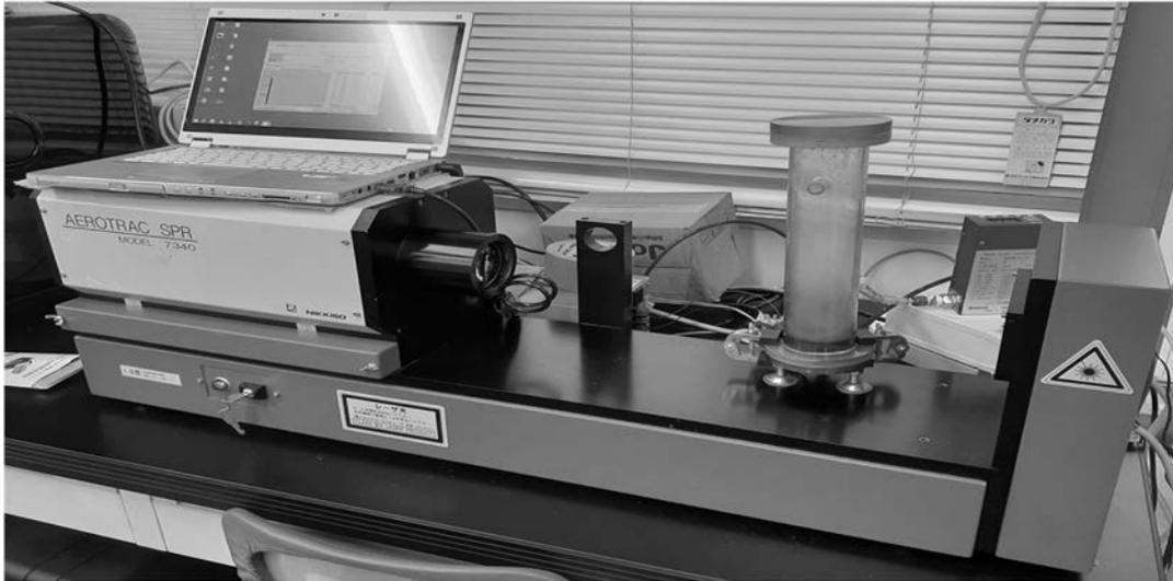
図2 ミスト径の測定装置と霧化装置の外観
