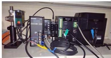
図1 O社の変位計の追加による計測器の整備
