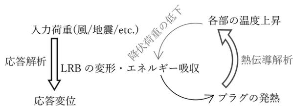
図3 LRBの熱・力学連成挙動解析
