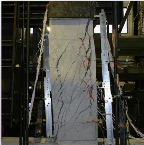
図 1 高強度鉄筋を用いた RC 柱の繰返水平加力実験
