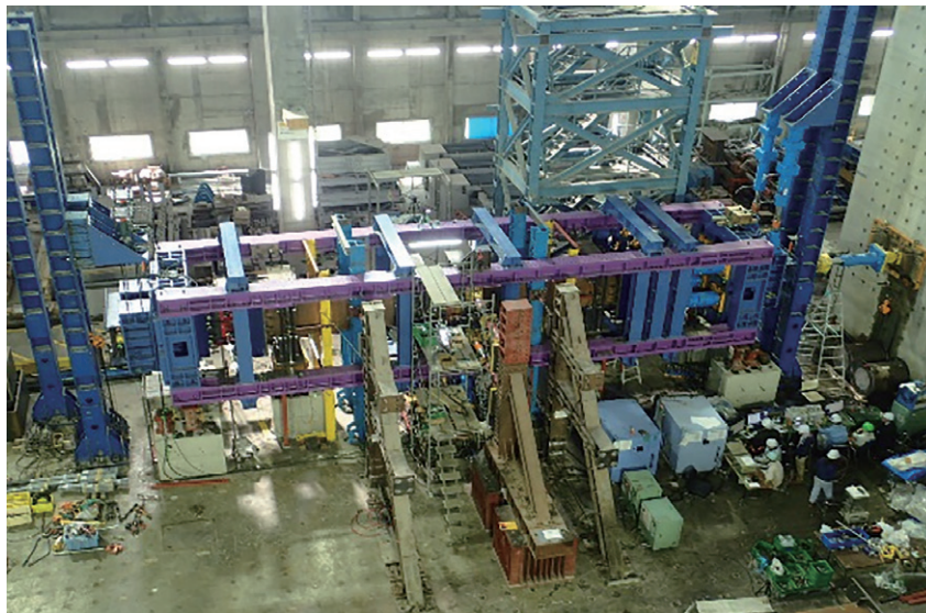
写真：圧縮 2000t・引張 800t の荷重装置を使用した杭の荷重実験風景（直径 1200mm・長さ 8m の場所打ち鋼管コンクリート杭を荷重フレーム中央に設置しているが、残念ながら写真では杭がよく見えない。実験では、2000t の圧縮軸力と 500t のせん断力を作用させて、杭が破壊するまでの過程を観察した。）
