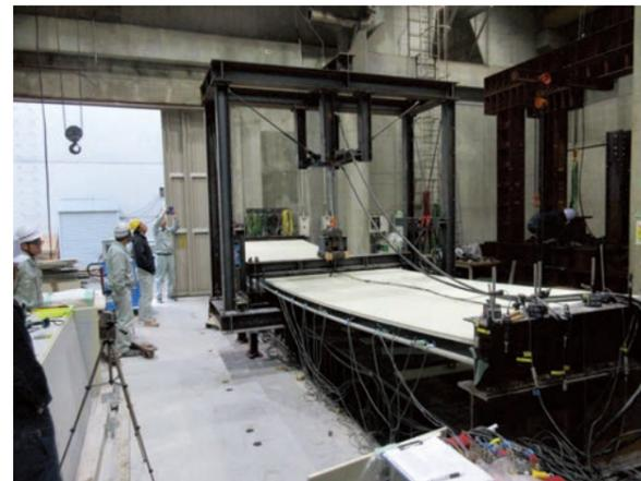
写真2 物流倉庫などを想定した高さ8mのLGS間仕切り壁の面外加力実験の様子である。油圧ジャッキによって壁中央を下方に押し込み、その抵抗力や破壊性状を観察している。
