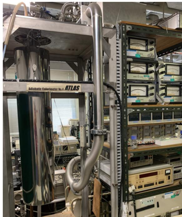
図 断熱型精密熱容量測定装置
