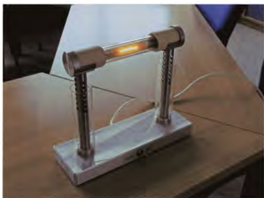
写真2 教育用に製作されたネルンスト・グローア。ジルコニアのイオン伝導で自己発熱している。製作と撮影場所は、Justus-Liebig-University, Giessen の Janek 教授のグループ。
