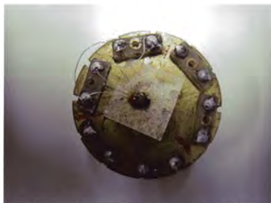
マクロな熱膨張を観察する歪みゲージに貼り付けた試料
