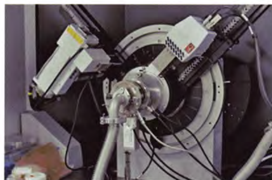
ミクロな格子定数変化を調べるX線回折装置
