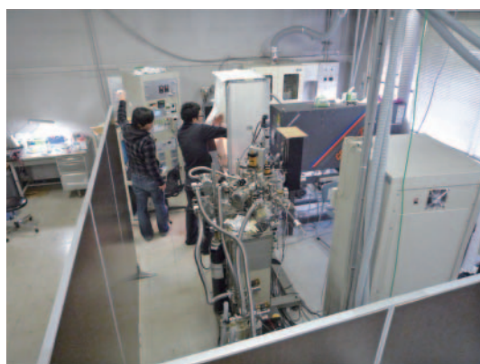
実験室風景：KrF エキシマレーザー 1 台と超高真空チャンバー 2 台を組み合わせた製膜システム。
