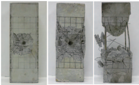
図2 10mm のステンレス球を種々のスピードで衝突させた鉄筋コンクリート柱 (1/10 モデル) 左:0.68km/s, 中央:1.11km/s; 右:1.77km/s
