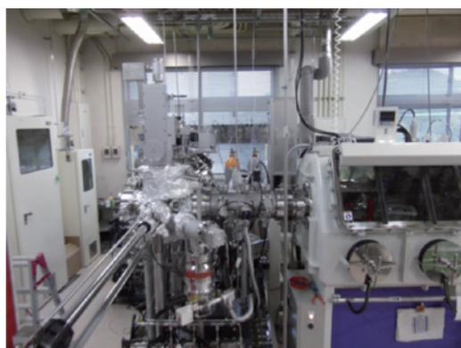
写真1 パルスレーザー堆積法/分子線エピタキシー装置
