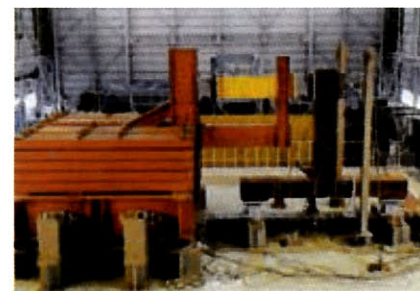
大型振動台を用いた部分架構の実大動的破壊実験
