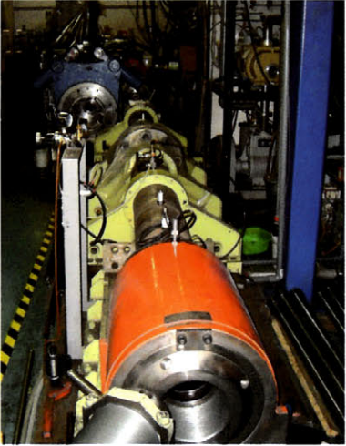
飛翔体を秒速4kmに加速できる二段式軽ガス銃
