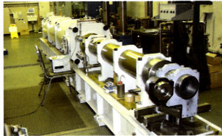
鉄筋コンクリートの安全な壊れ方機能を探索する大型衝撃銃
