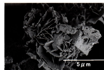
セメントを数秒で固化させる 2CaO \cdot Al_2O_3 ガラス- CaSO_4 系の水和生成物 (2 \{[Ca_2Al(OH)_6](SO_4)_{1/2}(H_2O)_3\})
