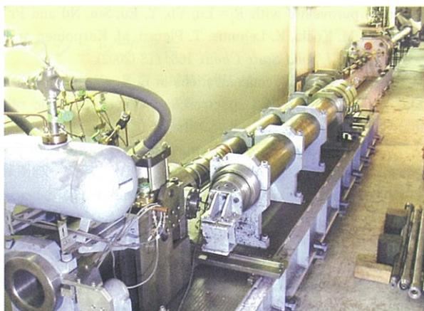
図1 全長10mの飛翔体自由飛行部を擁した三段式ガス銃の概観
