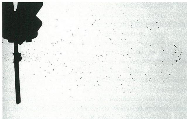
図3 高速飛翔体衝突実験における発生破片群の代表的なX線影絵写真
