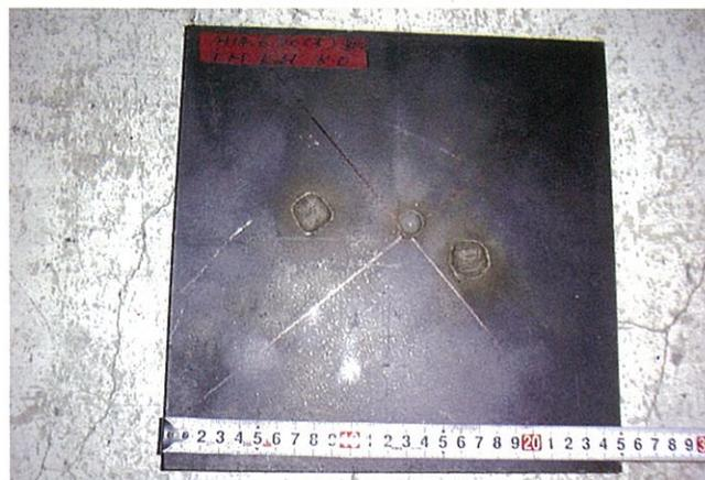
図2 アクティブサボ分離実験結果
