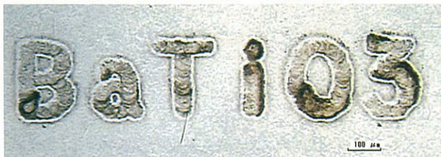
図1 室温水溶液中でレーザー照射により直接作製したBaTiO 3 結晶性膜マイクロパターン
