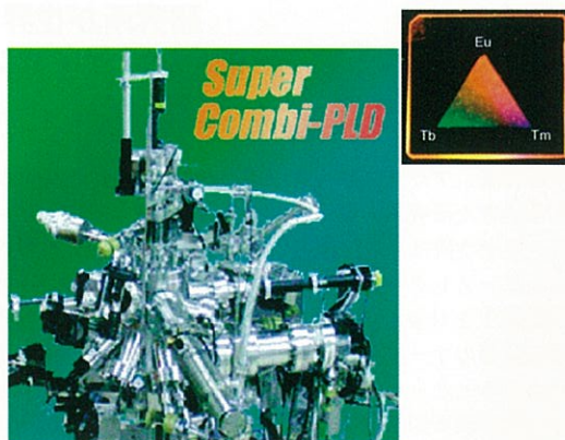
コンビナトリアルレーザー-MBE/PLD装置と蛍光体ライブラリー（吹出し）
