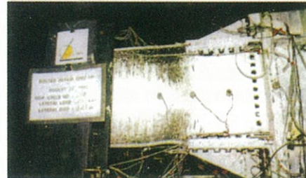
実物大鉄骨梁・柱・接合部の実験 (梁は高さ90cmのもの)
