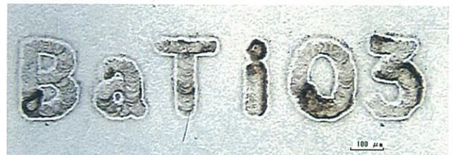
図1 室温水溶液中でレーザー照射により直接作製したBaTiO<sub>3</sub>結晶性膜マイクロパターン
