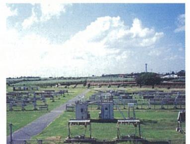
防水材料の屋外暴露試験
