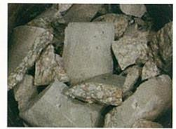
写真① 爆裂による表面コンクリートの剥落 (東工大・火災)
