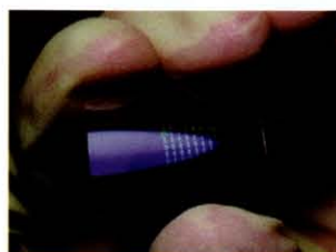
■図1 プラスチック上に作れる透明なトランジスタ。グニャグニャ曲がるディスプレイ実現のブレイクスルーになると期待されています。
