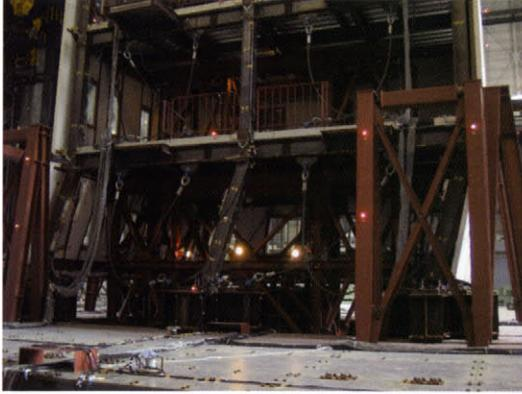
2007年9月に、世界最大の震動破壊実験施設である防災科学技術研究所E-ディフェンスにて、防災科学技術研究所、京都大学、大阪大学と共同で、実大鉄骨建物の完全崩壊実験を行った。写真は実験終了後の試験体建物の状況であるが、4階建ての建物の1階部分で大変形を起こし、安全装置の上に着座している。このような実大の建物を地震動で倒壊させる実験は世界初であり、建物がどのように壊れていくのかを検討する貴重なデータが得られ、解析技術のキャリブレーションなどに有効に活用されることが期待されているが、それだけに留まらず、準備段階を含め数多くの新たな研究課題も見つかった。これらの派生した研究テーマについては、逐次精力的に取り組んでいるわけであるが、その一つである合成梁-柱接合部の挙動に関する実験を、京都大学建築学専攻吹田研究室との共同利用研究として推進した。この研究では、現在の設計では考慮されていない床スラブの影響により接合部パネルゾーンに作用する力が低減される現象について、実験・解析の両面から詳細に検討することができた。また有意義な研究成果を得ることができただけでなく、新たな共同研究も始まっている。
