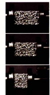
アルミニウム発泡材の圧縮変形挙動の観察
