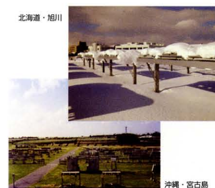
建築材料の屋外暴露試験
