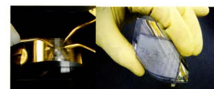
(左)アモルファス酸化物半導体を使って室温で作製した透明フレキシブルトランジスタ。有機トランジスタ、アモルファスシリコンよりも一桁以上優れた性能を示す。 (右)凸版印刷がアモルファス酸化物トランジスタを使って試作した電子ペーパー。
