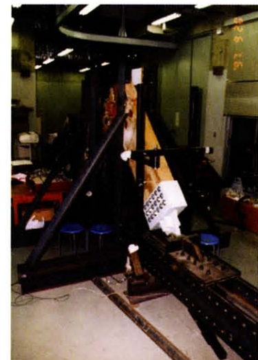
木構造物の加力実験
