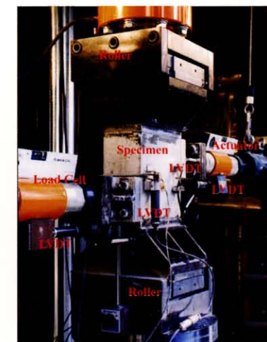
2軸加力試験装置
