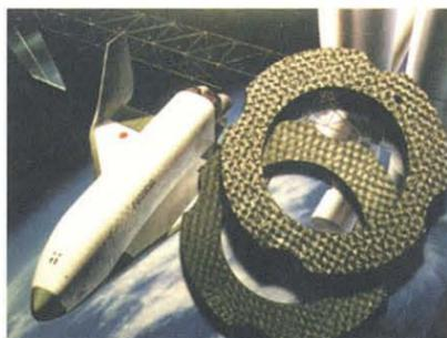
航空・宇宙用構造材料として活躍するC/C複合材料
