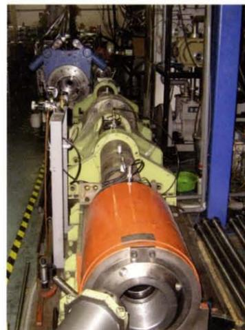
飛行体を秒速4kmに加速できる二段式軽ガス銃 (近藤研所有)
