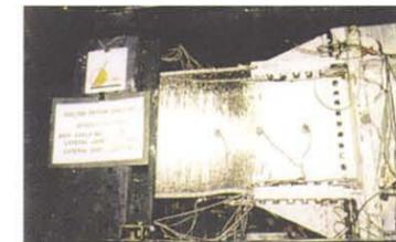
実物大鉄骨梁・柱・接合部の実験
