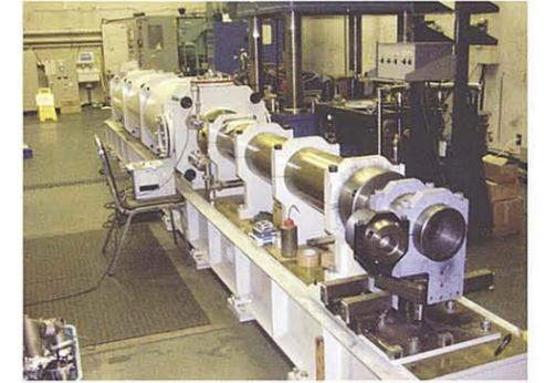
鉄筋コンクリートの安全な壊れ方機能を探索する大型衝撃銃
