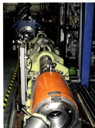
飛翔体を秒速4kmに加速できる二段式軽ガス銃(近藤研所有)
