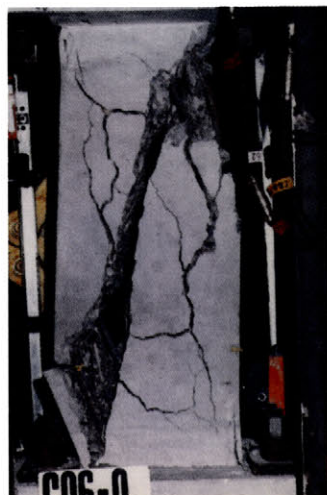
実験で再現した柱のせん断破壊
