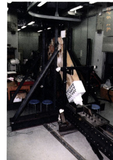
木構造物の加力実験
