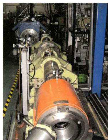
飛翔体を秒速4kmに加速できる二段式軽ガス銃 (近藤研所有)
