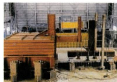
大型振動台を用いた部分架構の大動的破壊実験
