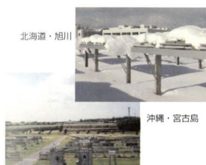
建築材料の屋外暴露試験
