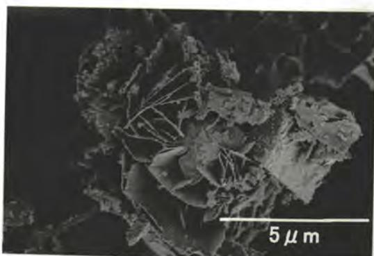
セメントを数秒で固化させる $2\text{CaO} \cdot \text{Al}_2\text{O}_3$ ガラス- $\text{CaSO}_4$ 系の水和生成物
