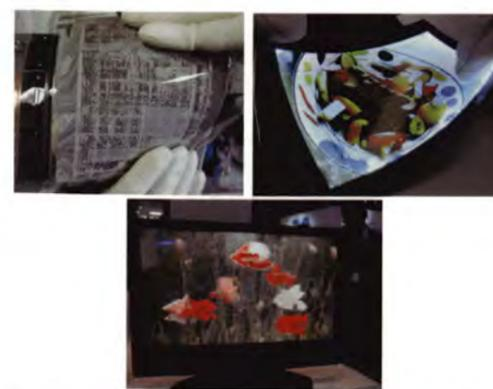
図2 アモルファス酸化物トランジスタを使ったディスプレイ試作品の例
