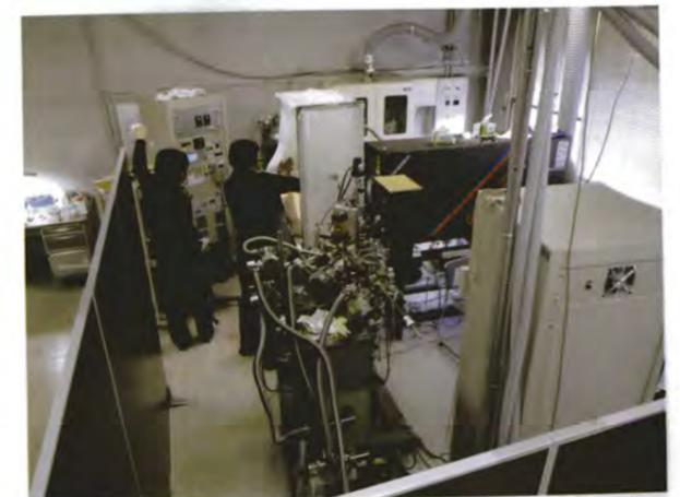
KrFエキシマレーザー1台と超高真空チャンバー2台を組み合わせた製膜システム。
