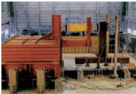
大型振動台を用いた部分架構の実大動的破壊実験 Full Scale Shaking Table Test of Beam-to-Column Connection
