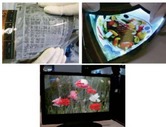
アモルファス酸化物トランジスタを使ったディスプレイ試作品の例 Prototype displays using amorphous oxide TFTs
