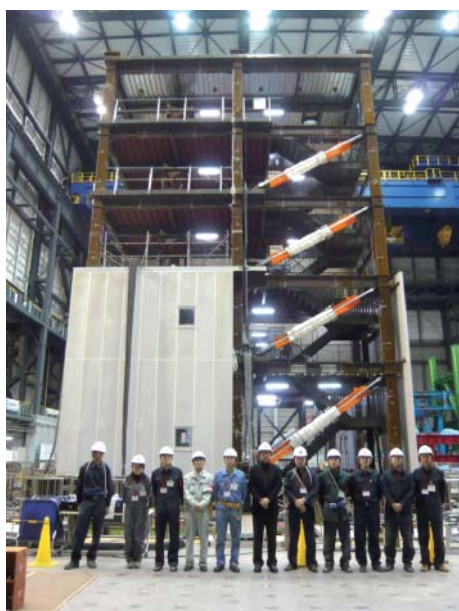
世界最大のE-Defense震動台を用いた実物大5階制振ビルの実験（神戸地震波を入力）
