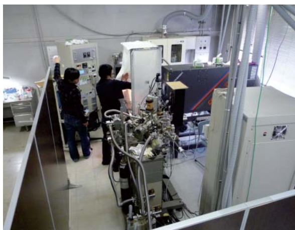
KrFエキシマレーザー 1 台と超高真空チャンバー2台を組み合わせた製膜システム。
