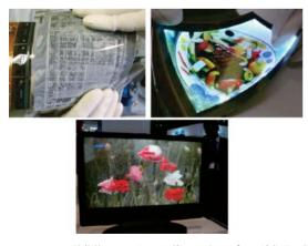
アモルファス酸化物トランジスタを使ったディスプレイ試作品の例 Prototype displays using amorphous oxide TFTs
