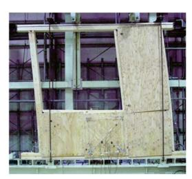
厚物構造用合板を用いた有開口床のせん断挙動に関する実験 Experiment on Shear Behavior of Thick Structural Plywood Sheeted Floor Framing with Opening
