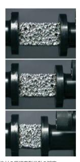
アルミニウム発泡材の圧縮変形挙動の観察 Observation of Deformation Behavior of Aluminum Foam under Compression
