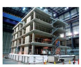
大型振動台を用いた高性能RC造建物の耐震性能確認 Shaking table test on real scale high performance RC buildings
