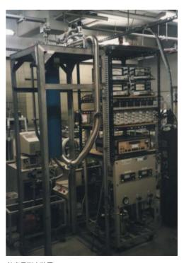
埶容量測定装置 High precision adiabatic calorimeter
