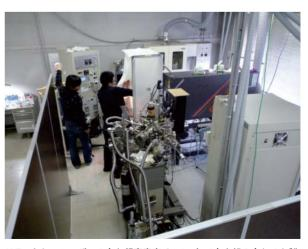
KrFエキシマレーザー 1 台と超高真空チャンバー2台を組み合わせた製膜システム。
