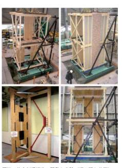
戸建て住宅制振構造の開発と実験(坂田研と共同) Development and Test for Wooden House with Passive Control System
