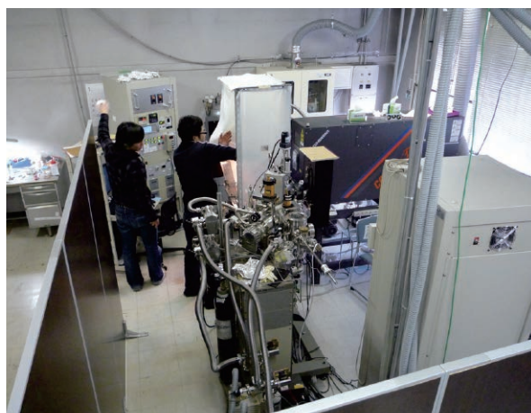
KrFエキシマレーザー1台と超高真空チャンバー2台を組み合わせた製膜システム。 Pulsed laser deposition system (one KrF excimer laser and two ultrahigh vacuum chambers)
