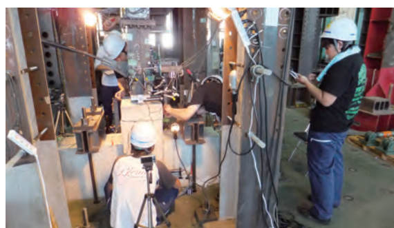
図2 露出柱脚の基礎コンクリート周辺ひび割れに基づく損傷評価に関する実大実験
