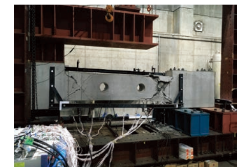
開口を有する鉄筋コンクリート梁の構造実験 Loading Test on the Performance of Reinforced Concrete Beam with Opening
