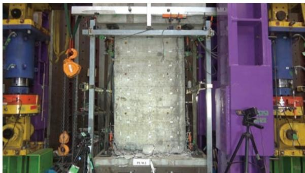
地震を模擬したRC壁の載荷を行い、コンクリートが損傷していく様子を記録し数値モデルをする際に役立てる。
