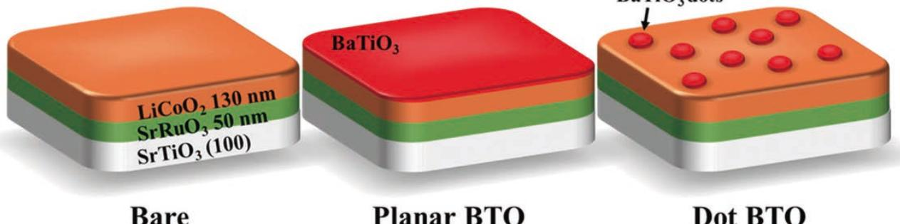
**Li イオンバッテリーにおける  $\text{LiCoO}_2$  正極のモデル構造**
