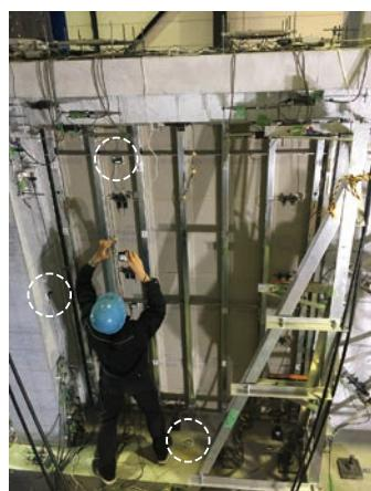
MEMSセンサを用いた変形測定法の検証実験
