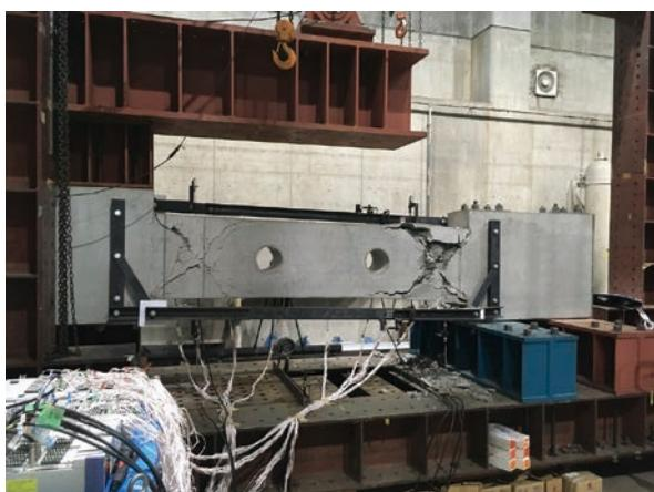
貫通孔を有するRC梁の加力実験
