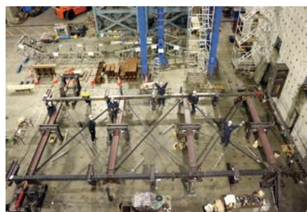
3層実大プレース架構の破壊実験
