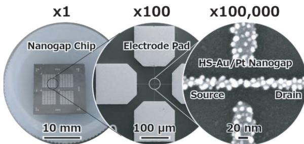
コア技術：電子線リソグラフィ(EBL)で作製したギャップ長6nmの白金ナノギャップ電極
