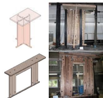
CLT パネル工法による耐力壁の
