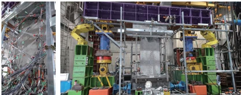
RC壁の載荷実験状況と、変形を測定するための変位計設置状況
