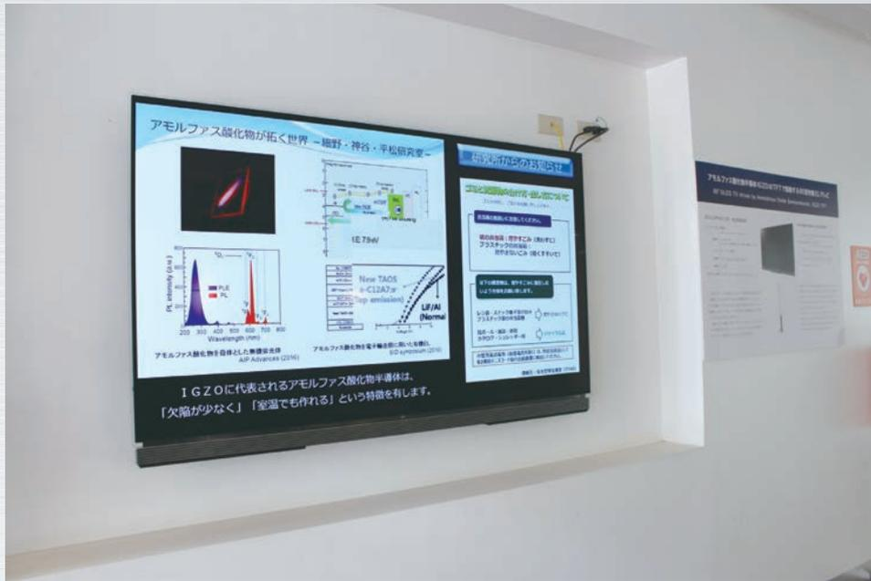
応用セラミックス研究所（フロンティア材料研究所前身）が2004年に開発した a-IGZO TFT（Nature 誌掲載）を使うことにより実用化された大型有機 ELTV。（65型 解像度4K）
