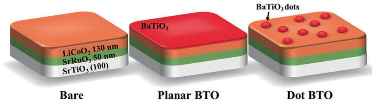
**Li イオンバッテリーにおけるLiCoO<sub>2</sub>正極のモデル構造**
