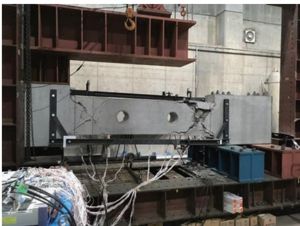
貫通孔を有するRC梁の加力実験
