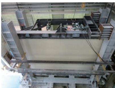
非構造壁の地震時挙動に関する実験（(国研)建築研究所との共同研究により実施）
