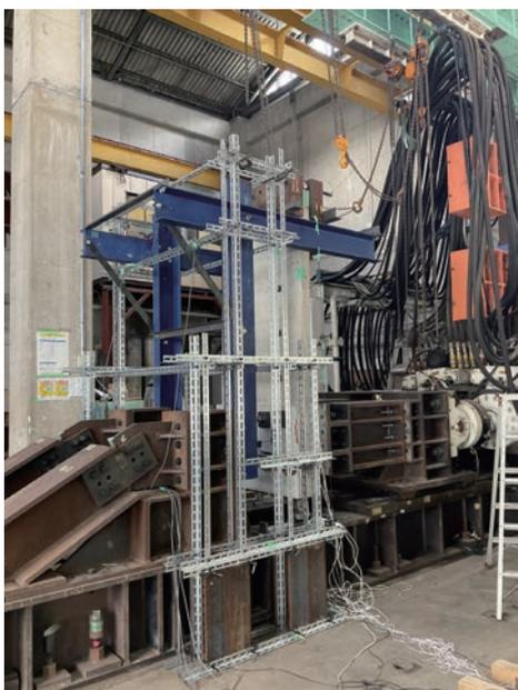
鉄筋コンクリート片持ち部材の振動実験
