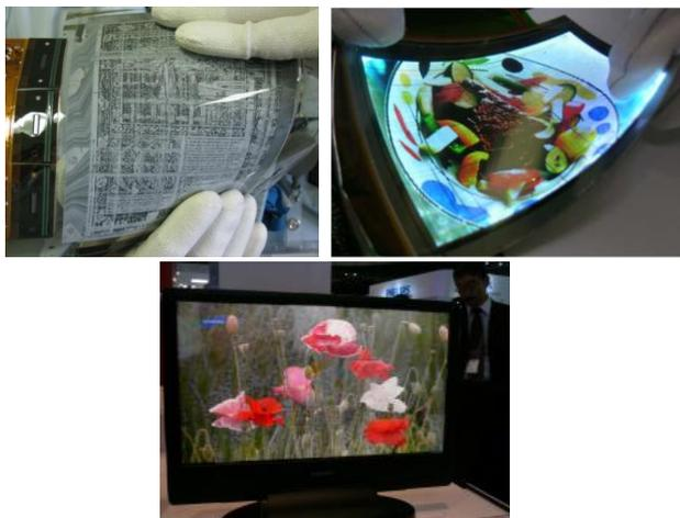
アモルファス酸化物トランジスタを使ったディスプレイ試作品の例
