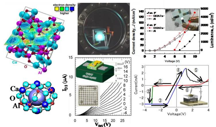
無機エレクトライド C12A7:e<sup>-</sup>の結晶構造、電子構造とデバイス応用の例
