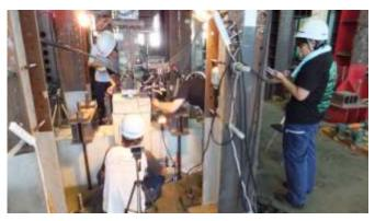
構造特性の把握と損傷評価法の構築を目指したブレース架構の実大実験
