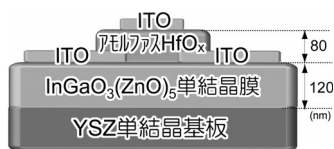
図6 \text{InGaO}_3(\text{ZnO})_5 単結晶薄膜を用いたトップゲート型透明トランジスタのデバイス構造
