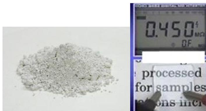
図4. (左) 未処理  $12\text{CaO} \cdot 7\text{Al}_2\text{O}_3$  (C12A7)粉末。普通のセメント材料と同じ白色。(右) は $\text{H}^+$ イオンを包接させて紫外光を照射したC12A7に抵抗テスターを当てたときの写真。普通のC12A7は絶縁体にもかかわらずこの試料は電気が流れる。
